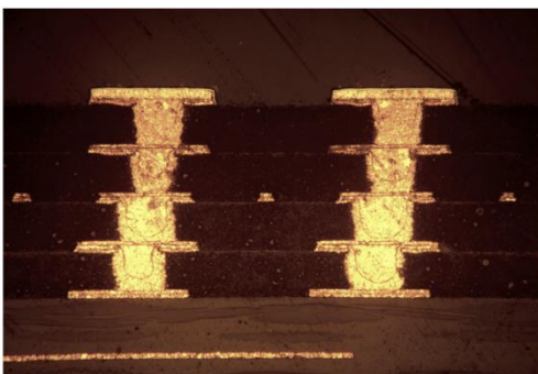
可用于多层堆叠微孔设计 (左图是4层堆叠微孔结构设计的截面图)
